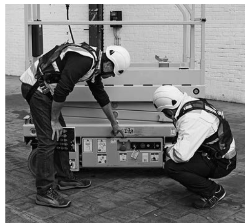
Fig. 3: gli operatori devono essere istruiti sull'uso della piattaforma di lavoro elevabile. L'addestramento deve basarsi sul manuale d'uso.
