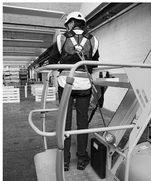
Fig. 1: con le piattaforme di lavoro a braccio articolato o telescopico il pericolo di caduta dall'alto è maggiore. Ogni persona presente sulla piattaforma deve essere munita di un sistema di ritenuta (imbracatura e cordino regolabile lungo al massimo 1,8 m) e di un casco di protezione con cinturino sottogola.
