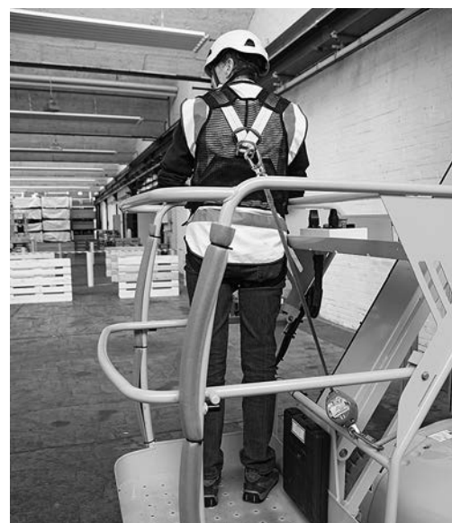
Fig. 5: quando si usa un sistema di ritenuta (arresto caduta) bisogna usare solo i punti di ancoraggio consentiti e mantenere i cordini il più possibile corti (consultare il manuale d'uso).
